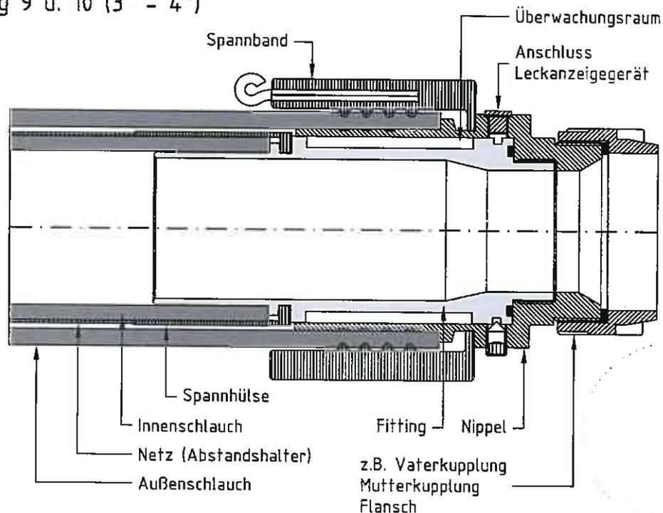
Flexible doppelwandige Schlauchleitung "System Klenk", Typ DWSL für den Transport wassergefährdender Flüssigkeiten bei Umfüll- und Abfüllvorgängen
