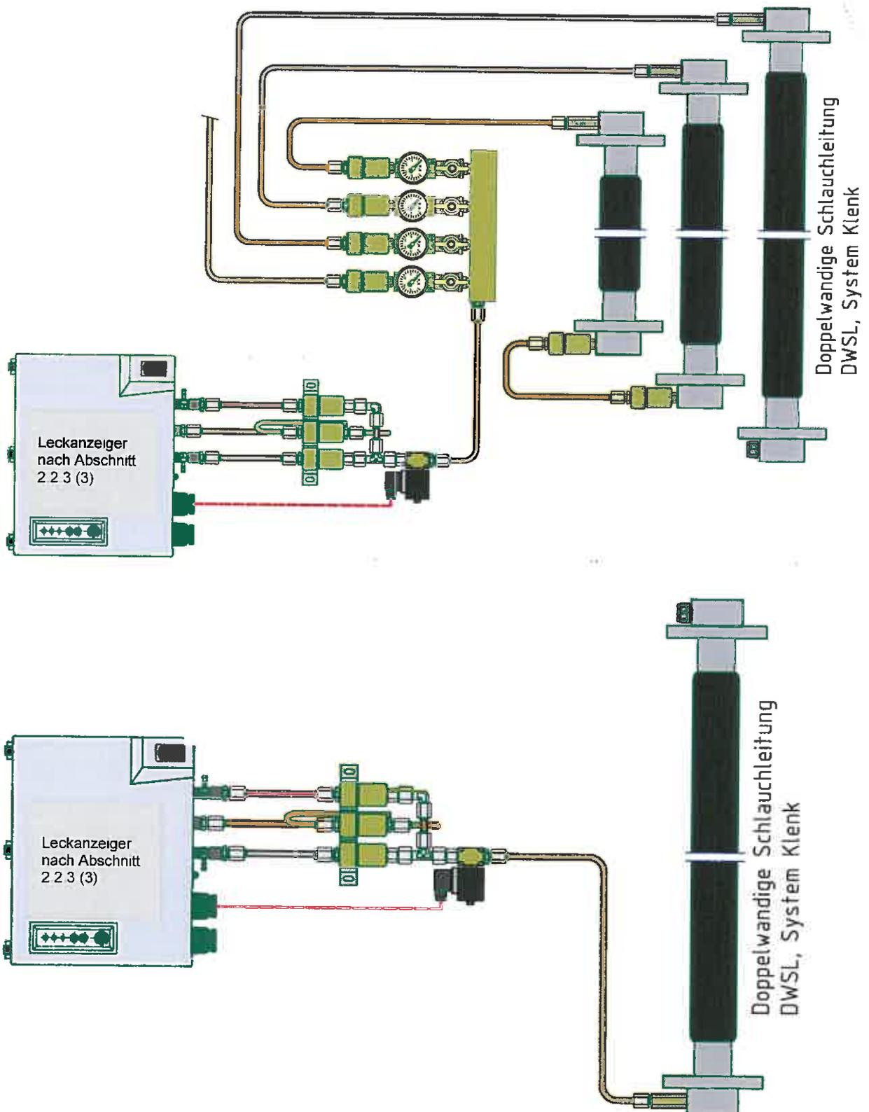
Flexible doppelwandige Schlauchleitung "System Klenk", Typ DWSL für den Transport wassergefährdender Flüssigkeiten bei Umfüll- und Abfüllvorgängen
