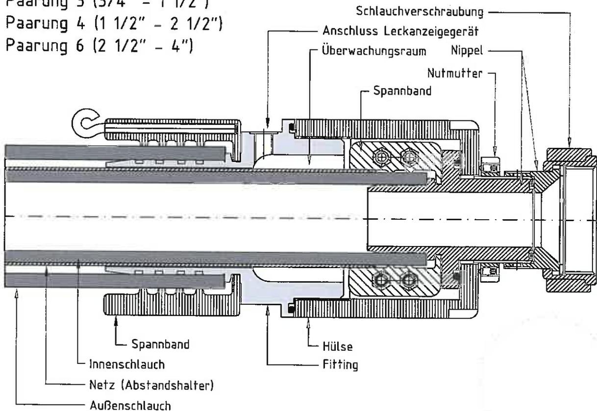
Flexible doppelwandige Schlauchleitung "System Klenk", Typ DWSL für den Transport wassergefährdender Flüssigkeiten bei Umfüll- und Abfüllvorgängen
